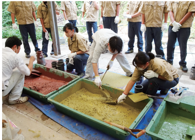
生徒が圧縮試験用の供試体を作製する
